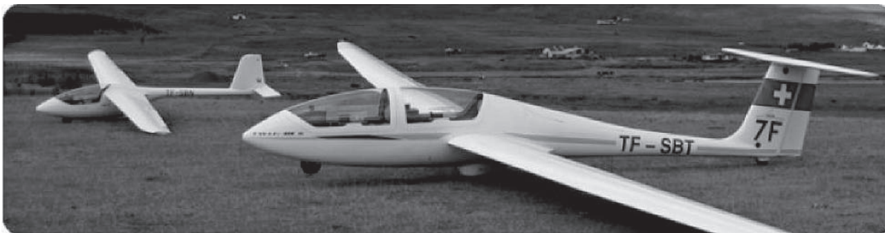
Á Melgerðismelum. Tveggja manna mótorsviffluga með innfeldan mótör nær, eins manns æfingasviffluga fjar.
